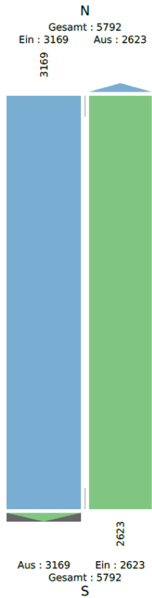
Bild A- 5: Querschnittsbelastung auf der Fritz-Jacobi-Straße im Bereich des Schulcampus (Vorher-Erhebung 1) [Kfz/24h]
